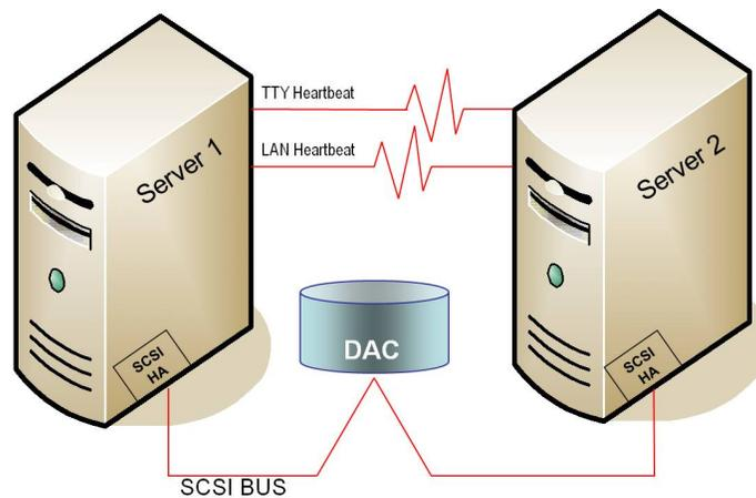
この構成マップの例は、ディスクアレイサブシステムを共有する LifeKeeper サーバのペアを図示しています。通常は、Server 1 がアプリケーションを実行し、Server 2 がバックアップサーバまたはセカンダリサーバになります。このケースでは、同時に1つのサーバがディスクアレイのディスクストレージスペース全体を保有しているため、ディスクリソースの競合はありません。ディスクアレイコントローラは「DAC」、SCSI ホストアダプタ (パラレル SCSI、ファイバチャネルなど) は「SCSI HA」と表記されています。
